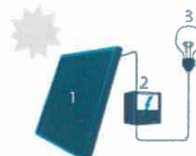
Fig. 1: Zonnepanelen met een kleine elektrische installatie (bijv. een lichtbulb).
